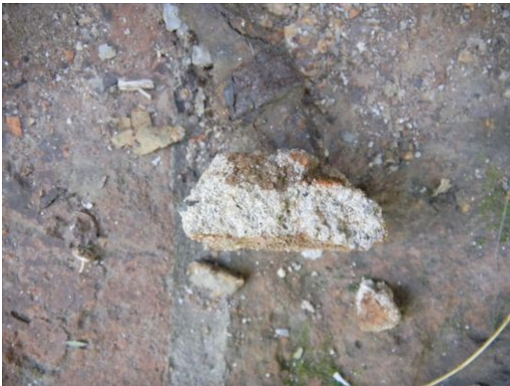
Fot. 43. Oryginalna zaprawa użyta do murowania ścian fortu.
